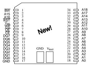
34-Pin POWERCAP MODULE (PCM) (USES DS9034PC POWERCAP)
